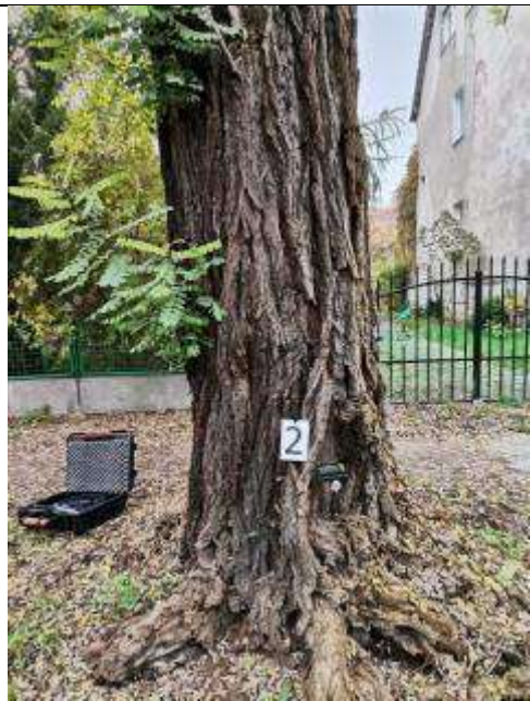
Fot. 8. Robinia, ul. Odkrywców 23, Wrocław. Próba obciążeniowa - mocowania czujników -- strona rozciągana
