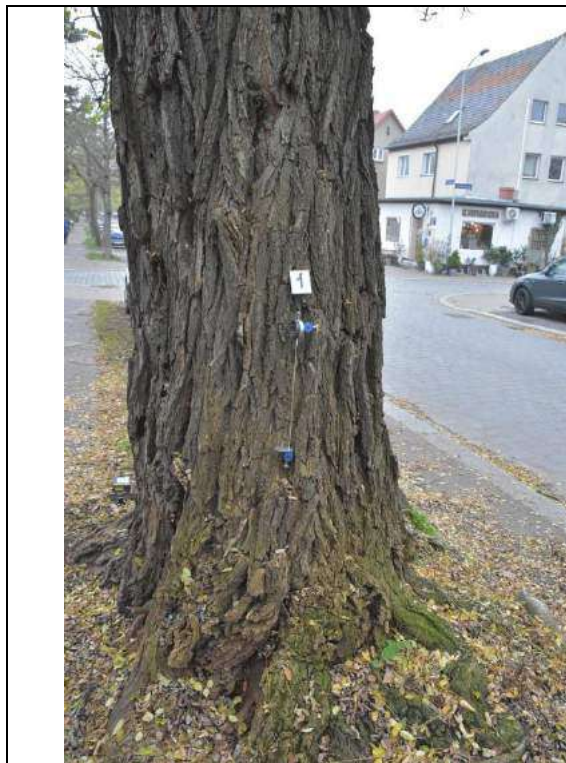
Fot. 7. Robinia 46-32, ul. Odkrywców 4, Wrocław. Próba obciążeniowa - miejsce mocowania czujników - strona ściskana
