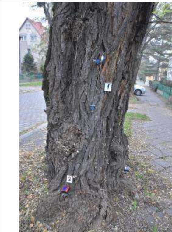
Fot. 7. Robinia 30-10, ul. Odkrywców 28, Wrocław. Próba obciążeniowa - miejsce mocowania czujników - strona ściskana
