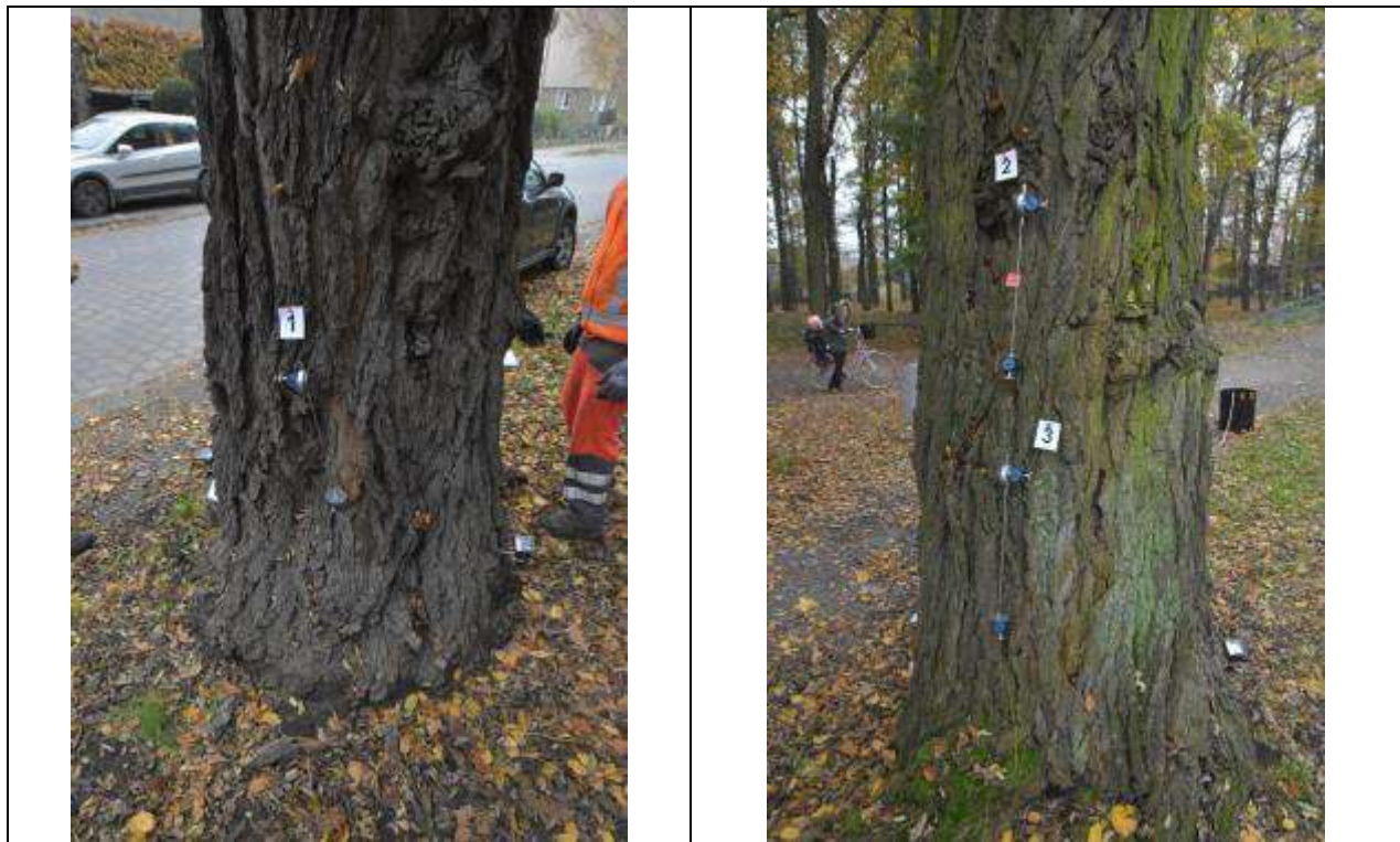
Fot. 7. Robinia 32-17, ul. Odkrywców przy parku, Wrocław. Próba obciążeniowa - miejsce mocowania czujników - strona ścisłkana
