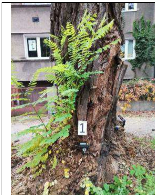
Fot. 5. Robinia 37-22, ul. Odkrywców 33, Wrocław. Próba obciążeniowa - miejsce mocowania czujników - strona ściskana
