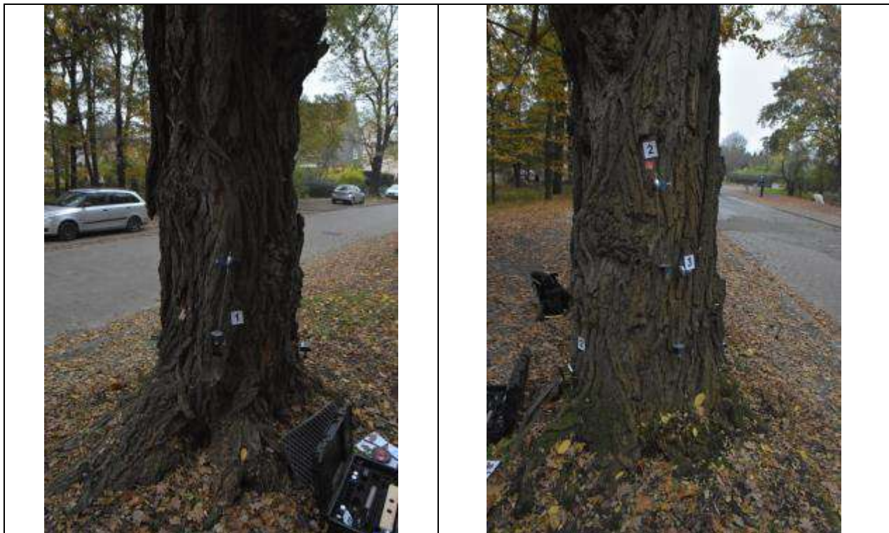
Fot. 7. Robinia 33-18, ul. Odkrywców przy parku, Wrocław. Próba obciążeniowa - miejsce mocowania czujników - strona ścisłkana
