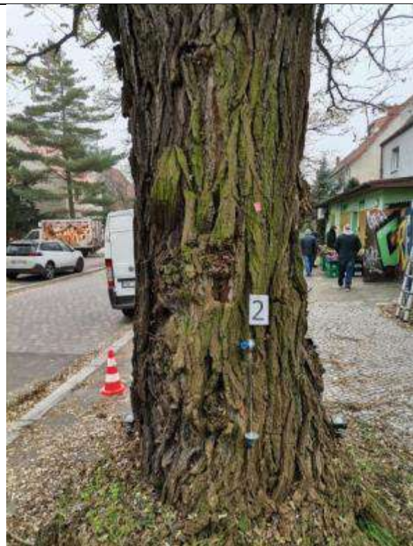
Fot. 6. Robinia, ul. Odkrywców/ Wędrowców, Wrocław. Próba obciążeniowa - mocowania czujników — strona rozciągana
