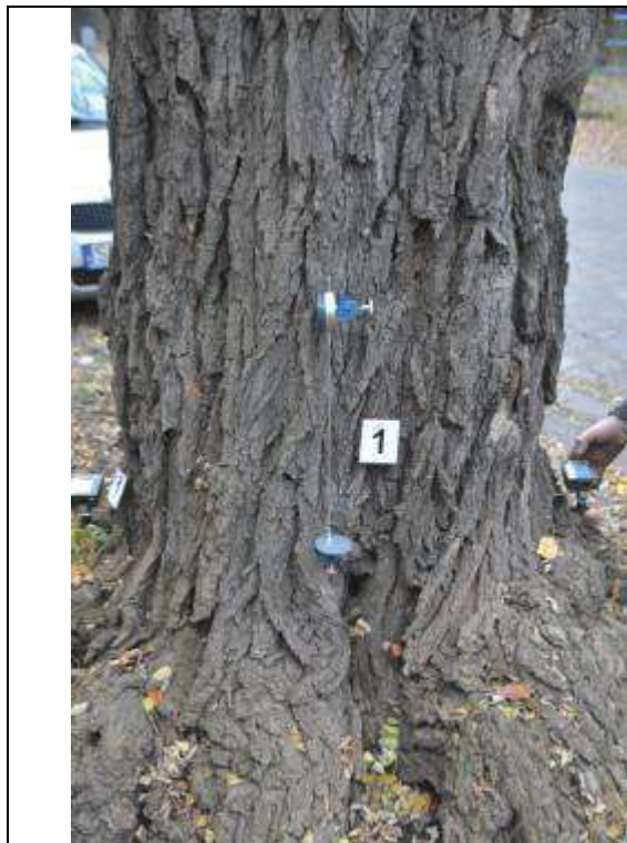
Fot. 7. Robinia 35-20, ul. Odkrywców przy parku od W, Wrocław. Próba obciążeniowa - miejsca mocowania czujników - strona ściskana
