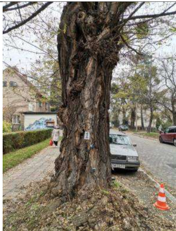
Fot. 5. Robinia 42-28a, ul. Odkrywców/ Wędrowców, Wrocław. Próba obciążeniowa - mocowania czujników - strona ściskana
