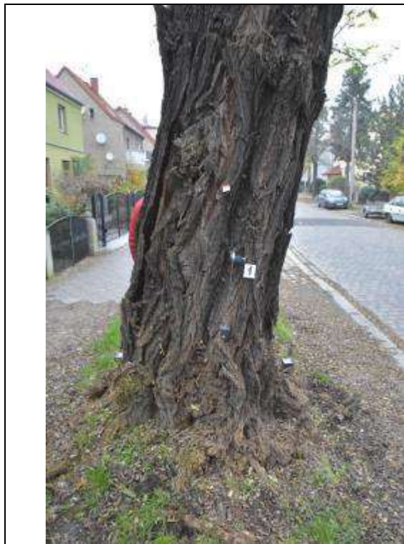
Fot. 7. Robinia 45-31, ul. Odkrywców 13 od N, Wrocław. Próba obciążeniowa - miejsce mocowania czujników - strona ściskana
