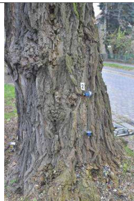
Fot. 10. Robinia 23-3, ul. Odkrywców 16, Wrocław. Próba obciążeniowa - miejsce mocowania czujników — strona rozciągana
