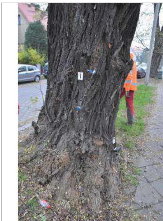
Fot. 9. Robinia 23-3, ul. Odkrywców 16, Wrocław. Próba obciążeniowa - miejsce mocowania czujników - strona ściskana
