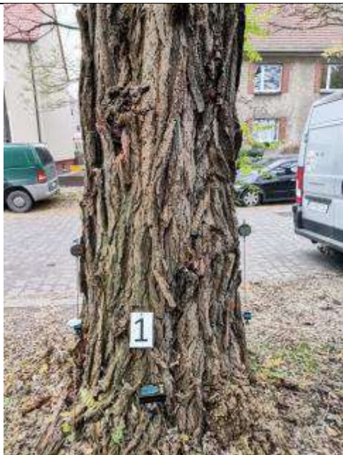
Fot. 7. Robinia 40-26, ul. Odkrywców 23, Wrocław. Próba obciążeniowa - mocowania czujników - strona ściskana
