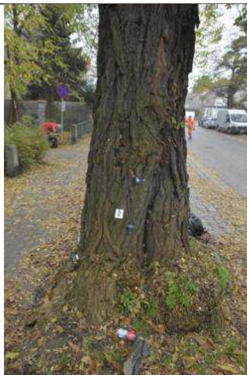
Fot. 10. Robinia 21-1, ul. Odkrywców 2a, Wrocław. Próba obciążeniowa - miejsce mocowania czujników -- strona rozciągana
