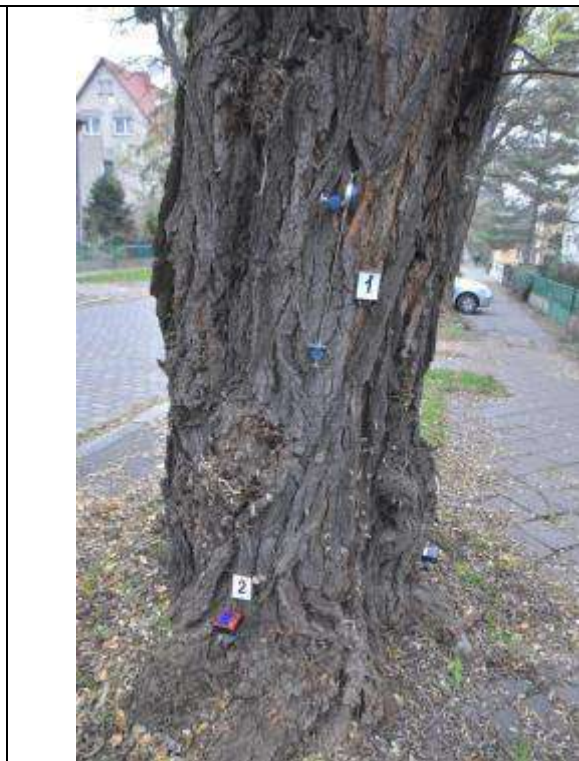
Fot. 8. Robinia 30-10, ul. Odkrywców 28, Wrocław. Próba obciążeniowa - miejsce mocowania czujników — strona rozciągana
