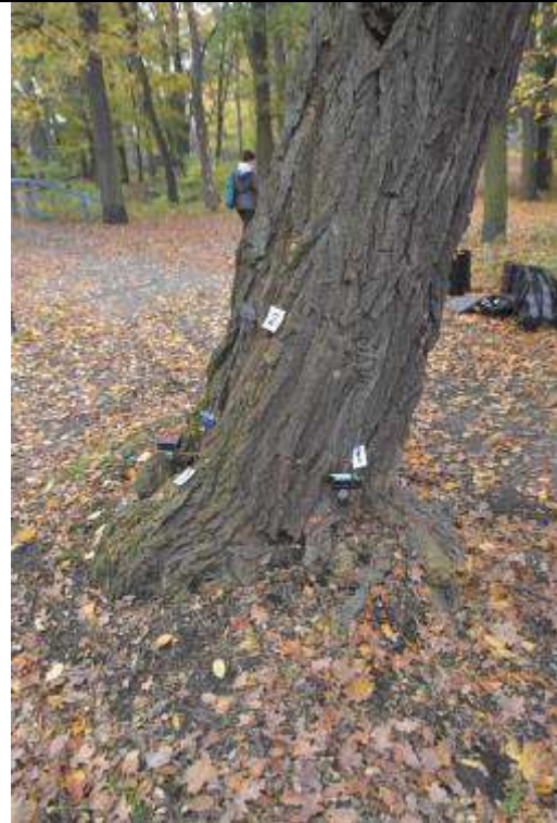
Fot. 8. Robinia 34-19, ul. Odkrywców przy parku, Wrocław. Próba obciążeniowa - miejsce mocowania czujników -- strona rozciągana
